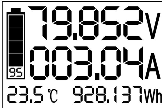
说明: 可通过按键切换最下面一行显示内容(功率、温度、电量Ah、电能Wh)。
