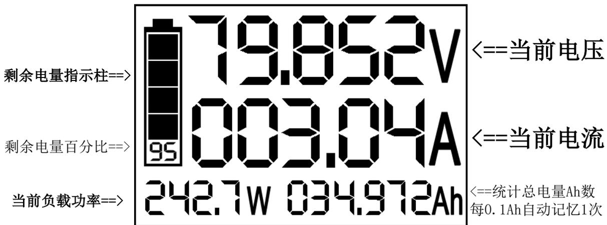
说明：默认电压测量范围0~200V，100V以内显示3位小数，超过100V自动切换为显示2位小数。
