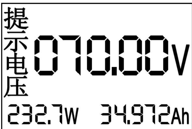
说明: 按“SET”键切换到设置“提示电压”界面, 可设置高低电平信号输出切换的电压值(扩展功能)。
