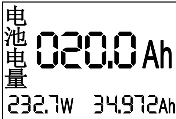
说明: 按“SET”键切换到设置“电池电量”界面, 可选择应用不同的电瓶, 与主界面上电量指示柱对应。
