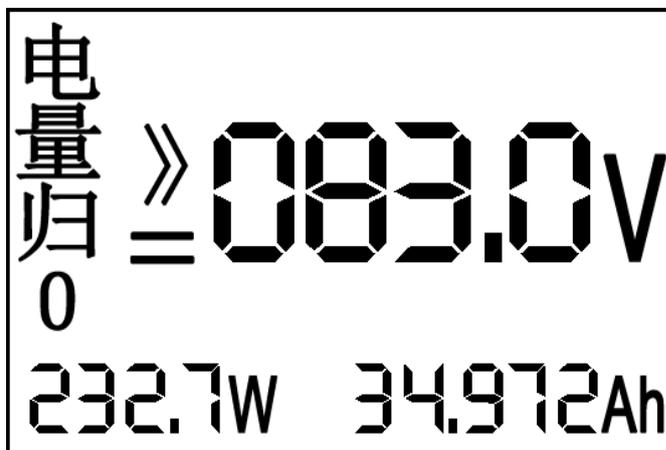
说明: 按“SET”键切换到设置“电量归0”电压界面, 可选择超过某电压值后自动把统计的电量归0。
