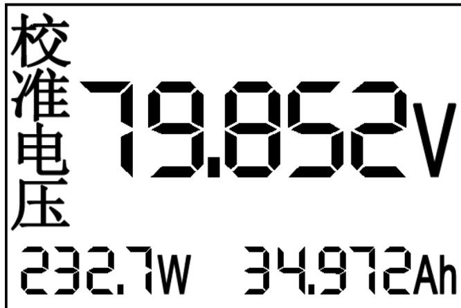
说明: 按SET键切换到“校准电压”界面, 然后按“+1”和“-1”微调校准电压值。
